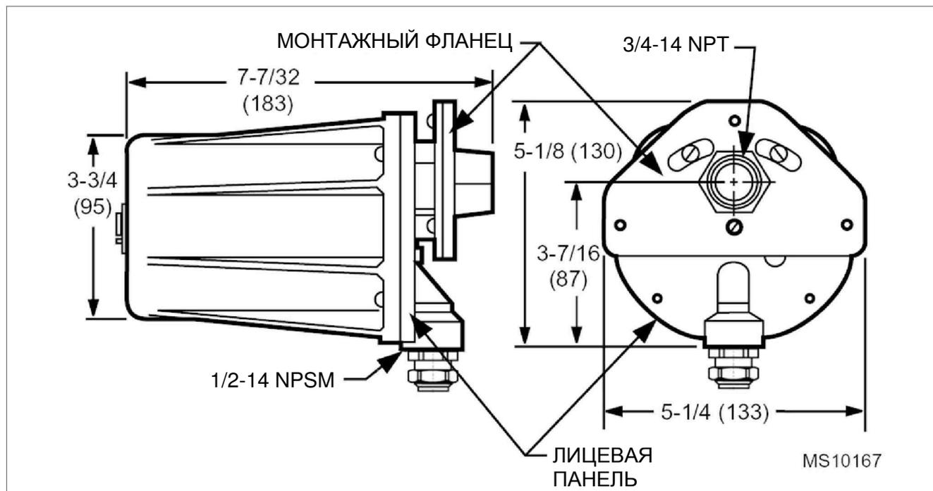
Рис. 1. Размерный чертеж детектора модели S7061A, размеры в дюймах (мм)
