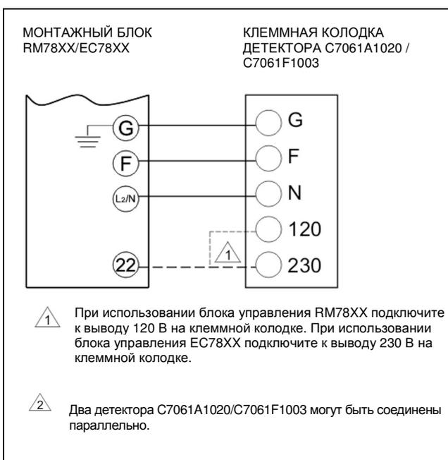
**Рис. 10\_3. Схема соединений детектора C7061A1020/C7061F1003 с блоком управления системы защиты пламени серии 7800 со схемой привода затвора датчика.**
