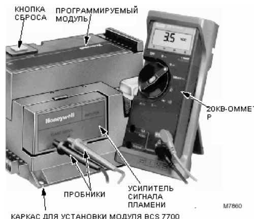
Рисунок 13. Измерение напряжения сигнала пламени BCS 7700
