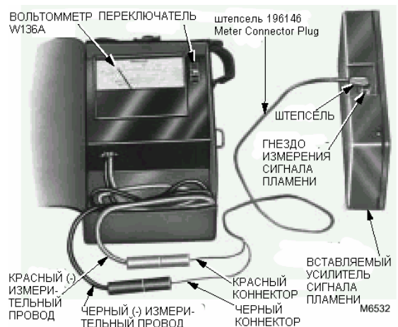
Рисунок 11. Измерение сигнала пламени в мкА
