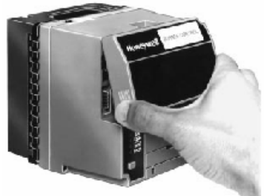
Рис. 10. Монтаж DATA CONTROLBUS MODULE™.
