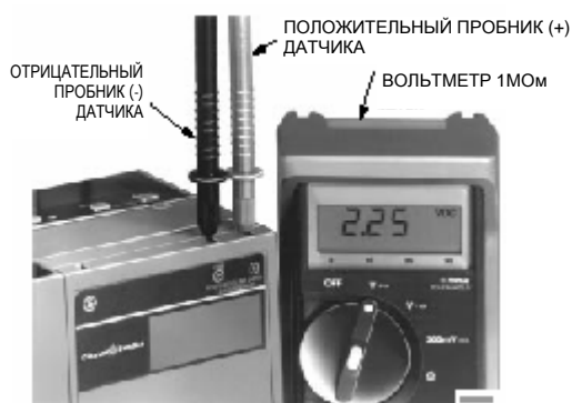
Рис. 22. Измерение сигнала пламени.
