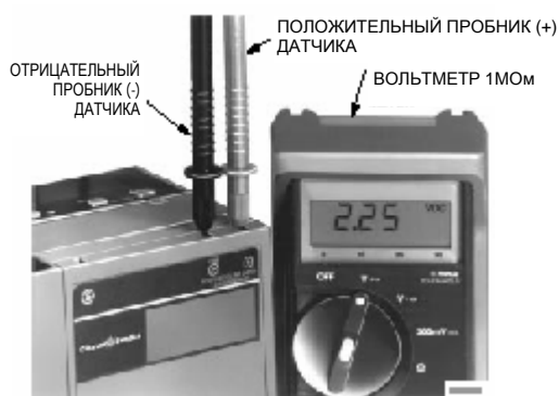
Рис. 22. Измерение сигнала пламени.
